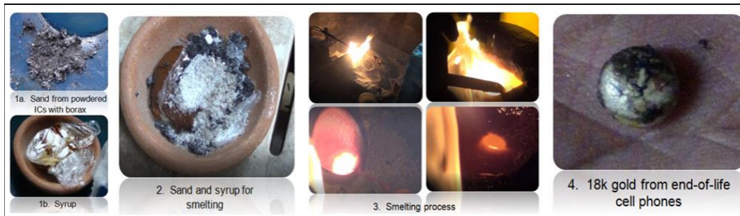
Fig. 5. Actual Smelting Process
