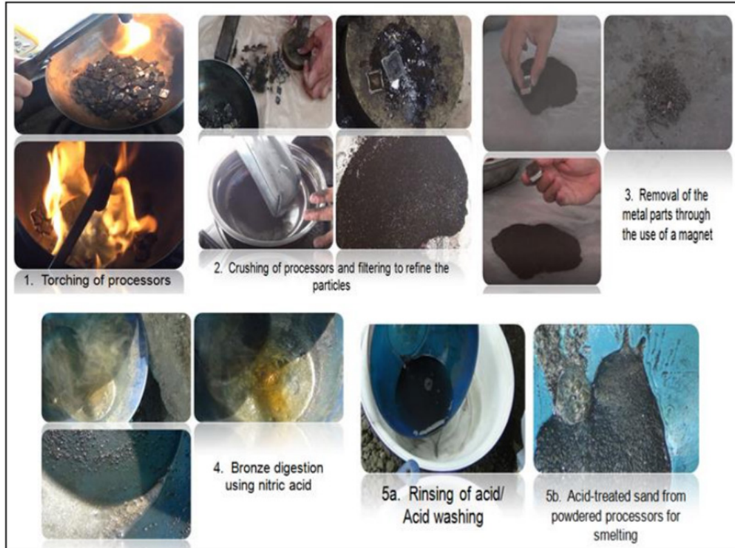
Fig. 4. Actual Acid Washing Process
